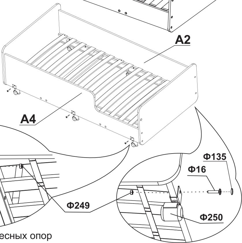
На заднее ограждение **A2** крепим колесные опоры **Ф250** с помощью винта **Ф16** и гайки **Ф249** как указано на рисунке.
